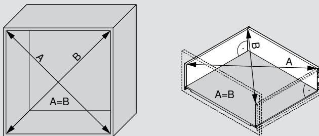
Para el juego del frente de al menos 2.5 mm se requiere una producción exacta, es decir, que se debe prestar atención a conservar las medidas planificadas y la precisión de los ángulos.
