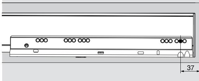
\* + 1 mm si las guías de cuerpo de mueble se instalan antes de montar el cuerpo
