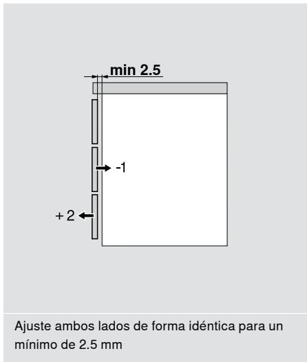
Ajuste ambos lados de forma idéntica para un mínimo de 2.5 mm
